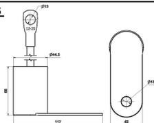
El descargador HGS 100 Ex está provisto, para su conexión, de cable extraflexible normalizado de 25 mm<sup>2</sup>.
